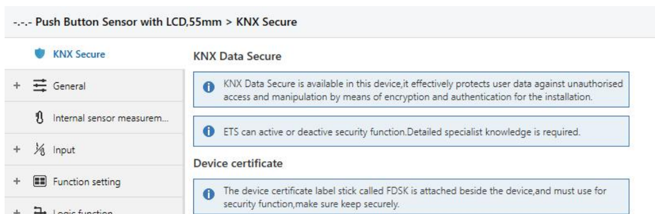
图 5.1 (1) “KNX Secure” 参数界面
