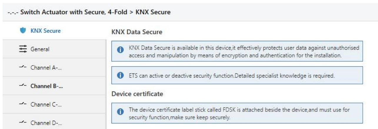
图 4.1 (1) “KNX Secure” 参数界面
